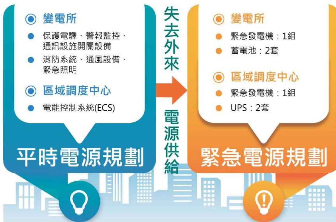
[圖 32] 關鍵基礎設施電源喪失時，維持正常運作之緊急電源規劃
